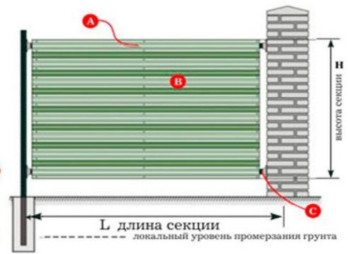
А - верхняя поперечина забора, В - евроштакетник от ТПК Центр Металлокровли, С - нижняя поперечина забора
